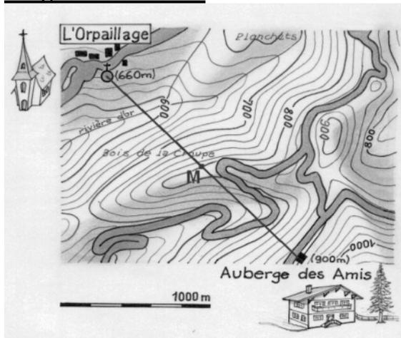
Sei A die Position des Beobachters bei der Auberge des Amis, M der Punkt der in Blickrichtung zur Kapelle auf dem Grat von La Croupe liegt und O der Fußpunkt der Kapelle. Durch senkrechte Projektion der Punkte O und M auf die Horizontale durch A erhält man die Punkte H und N. Die Sichtlinie von A über M führt zum Punkt S. Mit Hilfe der aus der Karte ersichtlichen Entfernungen und Höhenangaben erhält man über den Strahlensatz  $HS=200\text{m}$ . und damit  $OS=40\text{m}$ .
